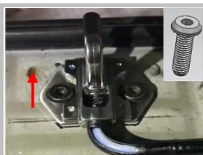
1.3 把我司锁扣组装上，根据箭头朝向正确安装，用两颗异形螺栓平行拧紧；
