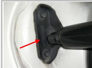
2.4 用我司配的左支架与原车螺丝安装，如图已安装好；支架上的箭头朝上安装，**注意**：采用贴美纹纸保护车漆
