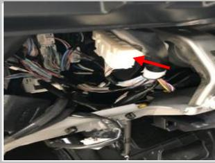
3.26\*18 款\*接 CAN 信号线 在驾驶室方向盘左侧，箭头指示白色插头；
