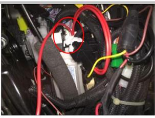
3.14 接正极线：看到如图原车插头；注意如图拍摄角度；
