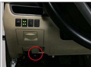
3.10 接正极线：需拆下主驾驶室内侧盖板，正极线束连接于此处位置；
