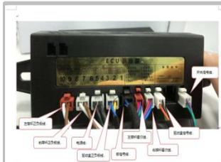
3.4 连接 ECU，待所有线束插好，最后插电源线插头；（插头如前面 ECU 插头说明示意图）
