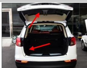
4.7 检查所有拆卸的装饰件是否全部锁紧，注意：安装时根据开关门的缝隙上下移动锁扣调整至合适位置；
