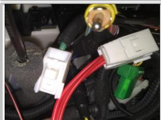
3.16 接正极线：拔下原车插头后，用我司正接取电器转接头插上；
