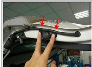
2.7 用夹扣在圆圈位置把线束固定好，使得波纹管平稳
