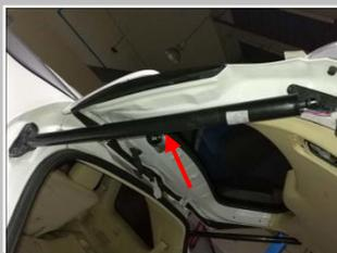
2.5 安装撑杆 把我司配的撑杆卡进原车支架固定头与我司支架固定头上；
