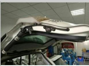
2.8 如图示意电机撑杆波纹管走线如图示意安装好，左右两边同样安装
