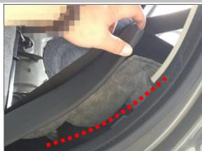
3.1 布正极线 将连接正极的线如图所示，通过尾箱后，把左 C 柱及迎宾踏板掀开，把正极线穿出（虚线）；同时把橙色解码器控制线从驾驶室反向延伸至上尾门处；
