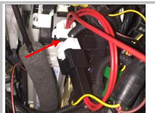
3.15 接正极线：正确找到如图示意原车插头；注意如图拍摄角度；
