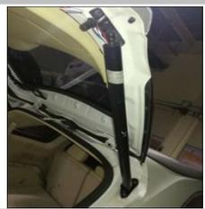
2.6 左侧撑杆安装完成，用同样方法安装另一边支架、撑杆；
