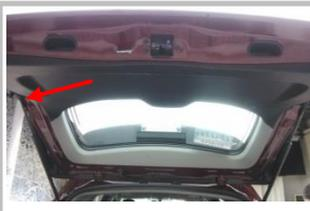
2.2 用一字螺栓刀把原车撑杆头翘起、拆下；**注意**：采用贴美纹纸包裹一字螺栓刀及撑杆头，以免刮花
