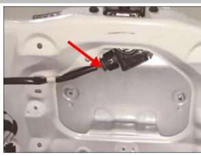
3.7 接门锁线：用我们配的转接线连接，再把我司转接线插头（箭头）插进上门锁；注意如图拍摄角度；
