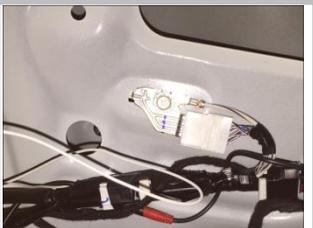
3.9 接负极：松动螺母，卡进负极连接片，卡紧后再还原拧紧螺母，
