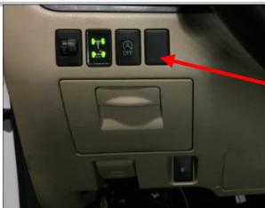
4.1 拆下此处原车空按钮 把我司配的中控按钮安装在此处位置；
