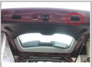
4.4 安装开关：此处拆下原车塑料件，用我们配的开关底座装上，然后开关按钮装上；
