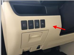
3.25\*18 款\*接 CAN 信号线 在驾驶室方向盘左侧，箭头指示白色插头；
