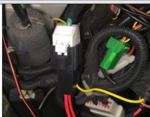
3.17 接正极线：用我司正极插头插转接复原固定好线束；
