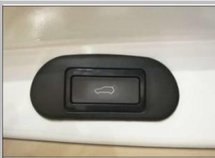
4.6 安装开关：把按钮开关装在底座上，再把底座还原安装；长按尾门加装开关15秒，可取消蜂鸣器提示音；
