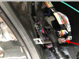
3.28\*18 款\*控制信号线（灰色线）的连接方法：拆掉驾驶室中控台左下角 A 柱的盖板可以看到要接的连接器位置（箭头），右下方灰色插头。
