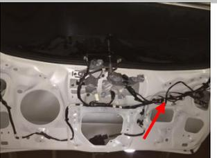
3.8 接负极：在尾门上门锁附近此位置找到原车不带油漆的螺栓柱即可，
